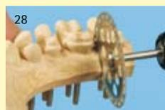
Scier les dies avec le disque diamanté Giflex.
