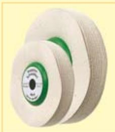
Il se compose de 24 rangées de tissu coton enduit de silicone. L'enduction de silicone renforce le polissoir et accentue son pouvoir abrasif notamment lors du prépolissage. En outre, cette enduction de silicone prolonge la durée de vie de la brosse.
