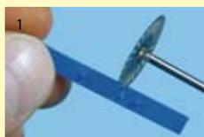
Gain de temps lors de la réalisation de la maquette grâce aux sphères vks intégrées. Avec un disque, raccourcir la barre à la longueur voulue et l'ajuster dans la zone d'édentement.
