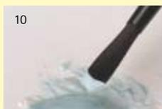
10 Les poils conservent toute leur tenue lorsqu'ils prennent la forme d'un spalter. C'est un gain de temps appréciable lors du montage de la céramique sur une infrastructure métallique.
