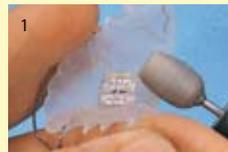
La granulométrie bien étudiée de la pointe à gros grain permet un meulage massif de larges surfaces en résine. La forme en creux limite le dégagement thermique.
