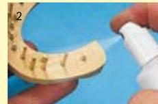
Le flacon spray permet d'isoler rapidement des surfaces importantes. Le fin brouillard de vaporisation assure une imprégnation homogène de la surface.
