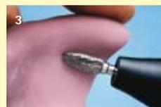
La denture croisée à grain moyen lisse la surface et permet un dégrossissage fin en une étape.
