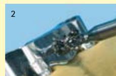
2 Grâce à l'ébauche réalisée, le Diatit-Multidril de diamètre 1,5 mm est bien dirigé.
