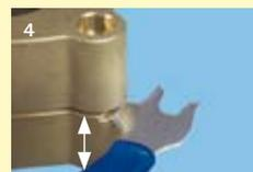
Le marteau latéral permet d'exercer une force plus importante avec un meilleur effet de levier pour l'ouverture des moules.
