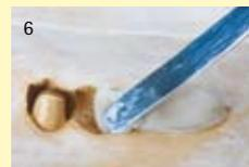
6 Couler la résine dans le moule sans inclure de bulles. Couler davantage de résine que nécessaire afin d'obtenir une condensation de la résine lors de la mise sous pression.
