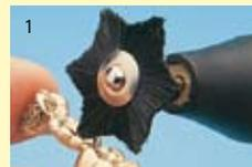
1 La forme en étoile, par son léger effet dynamique, assure un polissage jusque dans les sillons les plus profonds et élimine les éraflures en très peu de temps.
