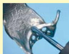
D237 KF 23: Grâce à sa denture fine, l'on obtient une surface lisse, même sur les alliages durs.
