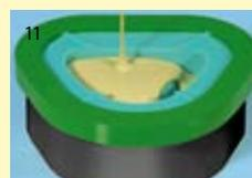
11 On remplit le moule de revêtement en s'arrêtant 5 mm avant le bord.
