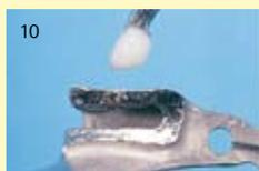
10 Le châssis squeletté et le boîtier de partie femelle sont recouverts d'une fine couche de colle DTK
