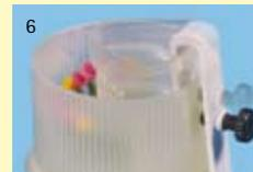
Il est possible de placer le contrôleur d'expansion à différentes hauteurs au niveau de la maquette pourvue des tiges de coulée. On économise ainsi du matériau de revêtement.
