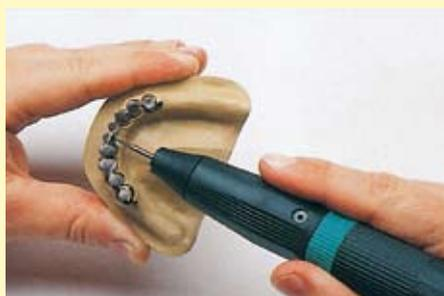
Même en présence d'alliages durs pour chassis métalliques, ce foret permet de réaliser sans difficulté des forages de précision. Grâce au revêtement anti-usure Diatit, le Multidrill à triple tranchant atteint jusqu'à 3700° de dureté Vickers (HV).
