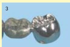
Sabler Oxyd-Stop macro avec des billes de verre à une pression de 3 bars max. Un léger polissage suffit pour restaurer la brillance de surface.
