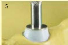
5 La partie fileté de la vis de fixation est recouverte de graphite colloïdal et vissée dans la douille fileté en exerçant une pression modérée.
