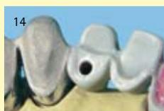
14 Faire pivoter l'auxiliaire de modelage avec une pince et le retirer.
