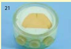
21 Les bouchons en silicone restent en place pour assurer la stabilisation jusqu'à fermeture de la cuvette.
