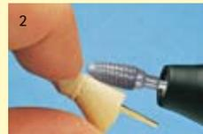
La grosse denture facilite les fraisages plus fins et évite au plâtre de se fendiller.
