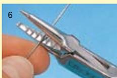
Enfiler le fil à crochets dans la cinquième encoche – celle que l'on a définie avec le gabarit de mesure.
