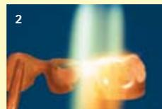
Oxyd-Stop argent palladium prévient l'oxydation de la pièce lors de la soudure au chalumeau et au four.
