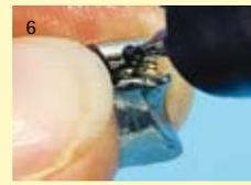
Avec le foret Multidrill (1,2 x 5) du jeu d'instruments, on fore sur une profondeur d'environ 2 mm. Pour éviter toute surchauffe du foret, ne pas hésiter à utiliser généreusement l'huile de forage.
