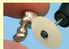
Aurogum à grain fin: une fois la surface préparée avec l'Aurogum à gros grain, il permet d'obtenir une brillance de miroir.
