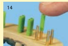
On enfonce les gaines Master-Pin sur les Master-Pins par leur extrémité la plus épaisse.
