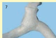
Sabler le surplus de fondant et les oxydes. Meuler la zone de brasage et polir. Superflux permet de réaliser d'excellentes connexions.
