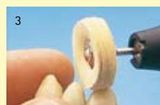
Le polissoir en peau de chamois ne provoque aucune surchauffe, les fines zones de transition vers le métal ne subissent aucune détérioration.
