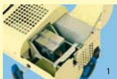
Le cycle de chauffe est accéléré par les éléments chauffants très performants. Ces éléments maintiennent la résine à une température constante - aucun risque de dégradation du matériau liée à une surchauffe.
