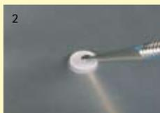
2 Afin d'éviter une dépression lors du démoulage, le bouchon de fermeture sera intégré de l'extérieur à la partie inférieure de la cuvette.
