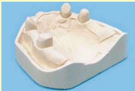
Brevest M1 étant un matériau dont l'expansion est parfaitement contrôlable, les conditions sont réunies pour réaliser un châssis bien ajusté.
