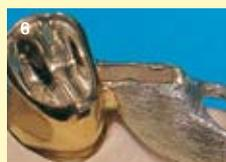
Le surdimensionnement de la partie secondaire de modelage est minime. C'est une garantie pour la précision de la soudure. La soudure de plusieurs ancrages secondaires doit s'effectuer de manière consécutive - toujours souder totalement une zone de jonction, contrôler la précision d'ajustage et ensuite seulement passer à la soudure de l'ancrage secondaire suivant.
