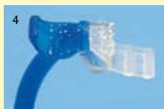
4 Avant la mise en revêtement, retirer la partie femelle vs 3 du boîtier et couler dans l'alliage souhaité.
