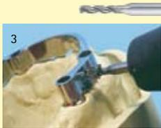
3 La barre est forée avec le Diatit-Multidrill, en utilisant copieusement de l'huile de fraisage et de forage.
