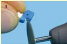
4 Meuler la préforme en céramique avec un disque à tronçonner de manière à l'ajuster dans la fermeture de l'ancrage à verrou puis...
