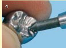
Abraso-Gum noir est extrêmement abrasif. Il est conçu spécialement pour les alliages non précieux. Ce polissoir caoutchouc permet de dégrossir et de surfaçer les pentes cuspidiennes directement après la coulée.
