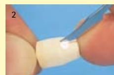
La mise de dépouille est facilitée grâce à une faible rétraction et une parfaite aptitude au grattage.
