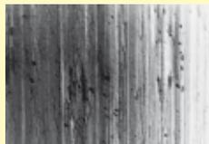
Photo au microscope électronique à balayage de l'intrados d'un élément secondaire télescope en alliage précieux - grossissement x 100.
