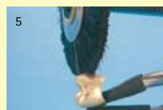
5 La petite brosette à noyau métallique avec des poils courts abrase la surface du métal. Il est ainsi possible d'éliminer les traces de dégrossissage.
