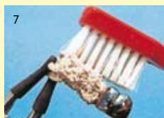
Après soudure, éliminer Oxyd-Stop-NP simplement et rapidement sous l'eau courante avec une brosse. C'est un gain de temps.
