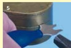
La surface de frappe sur le côté opposé évite de détériorer le manche et la lame du couteau.
