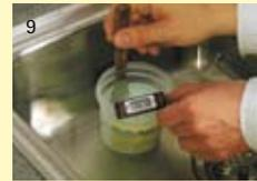
9 Le refroidissement s'effectue dans un bain d'eau froide à 40-45°C avec un malaxage continu du gel.
