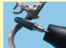
Dégrossissage rationnel des squelettés grâce à la denture KC de bredent.
