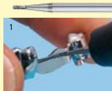
Avec le foret de centrage, on définit la position du verrou et l'on aménage une petite cavité.
