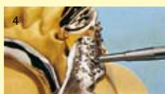
Avec le foret à pointer Diatit, on réalise l'amorçage qui permettra ensuite d'effectuer manuellement le forage pour la clavette.
