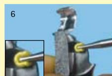
Insérer la partie femelle correspondante dans le boîtier avec la tige d'insertion prévue à cet effet.
