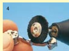
4 Le petit diamètre de la brosette est idéal pour le polissage des pièces fines, et fait gagner du temps.
