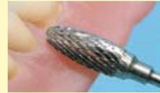
Grâce à la denture avec angle de dépouille, les pièces sont très bien surfacées. Le fonctionnement silencieux sans à-coup de la fraise sécurise le travail et offre un bon confort de travail.
