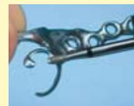
Surfaçage de zones d'accès difficile sur des châssis métalliques.
