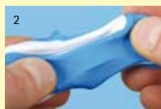
Après avoir mélangé les deux composants, la plage de manipulation est de 90-120 secondes. Les deux composants doivent être pétris jusqu'à obtention d'une consistance homogène.
