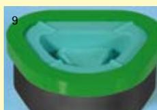
9 En cas de difficultés au démoulage, il est possible de retirer provisoirement la bordure.
