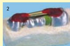
Pour les alliages non précieux, mélanger Brevest L avec Bresol L pour une expansion suffisante. Le bloc de soudure doit être aussi petit que possible.
