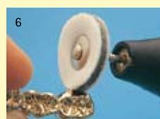
6 Les disques de toile imprégnés de pâte à polir assurent un polissage plus satiné. On gagne du temps à ne pas réaligner le disque en pâte à polir.
