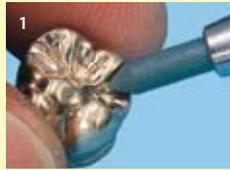
Les granulométries des polissoirs caoutchouc Abraso-Gum sont parfaitement harmonisées. Abraso-Gum bleu élimine les traces de meulage laissées par Abraso-Gum rouge.
