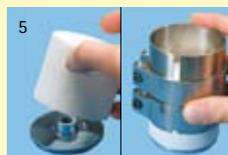
5 Remettre le cylindre sur le socle métallique et le cercler avec le manchon métallique qui ne doit se situer qu'autour du cylindre.
