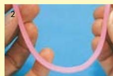
Grâce à sa consistance, la cire de montage se travaille parfaitement sans être chauffée.
