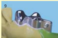
Placer l'auxiliaire de modelage 2,0 x 3,5 au centre du forage. Il fera office d'espaceur pour le modèle en revêtement. Préparer le modèle pour la duplication.
