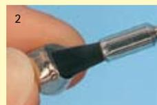
2 La brosette-pinceau, associée à Abraso-Star K80, facilite le polissage des zones difficiles d'accès, par ex. l'intrados des couronnes télescopiques.
