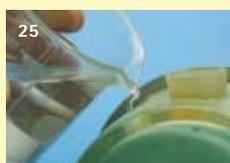
25 L'adjonction d'eau permet de différer la polymérisation. Pendant la polymérisation, il est ainsi possible de rajouter de la résine.
