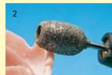
Grâce au diamant à grains extra-gros et au large diamètre extérieur, on obtient un meulage efficace d'excellente qualité. Idéal pour les larges surfaces de résine. La conception en creux permet une haute vitesse de tours sans dégagement thermique important.
