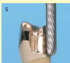
5 Après coulée et dégrossissage de la couronne, fraisage de la surface parallèle avec la fraise anatomique F137 3H 23.
