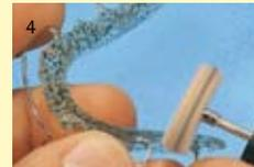
4 Les trois couches de feutre s'adaptent parfaitement à toute structure ce qui facilite les travaux de polissage les plus délicats.
