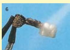
Après la cuisson ou soudure, la pellicule de protection se retire simplement sous l'eau chaude ou au jet de vapeur.
