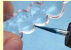
La résine se découpe avec précision et sans quasiment aucun copeau avec la fraise Diatit. Idéal pour les plaques thermoformées.
