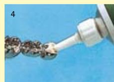
Appliquer Oxyd-Stop-NP directement du tube sur les pièces à protéger. L'embout doseur facilite la tâche.
