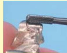
L'instrument N141 MH 23 pour le meulage d'un congé. Le fonctionnement sans à-coup et sans vibration de la denture avec dépouille sécurise l'utilisateur.
