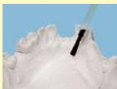
L'adhésif à cire Protek s'applique en couche fine sur le modèle et se diffuse dans le revêtement.
