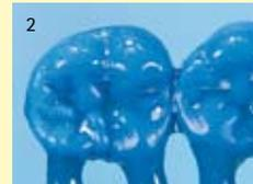
L'absence de tension à la surface de la cire assure une bonne pénétration du matériau de revêtement dans les plus fines parties sculptées de la maquette. Résultat: un état de surface lisse et parfaitement homogène - des surfaces masticatoires impeccables. Le flacon vaporisateur sert à appliquer Wax-Lite en couche très mince sur la cire.
