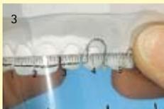
Le gabarit de mesure flexible permet de mesurer exactement la longueur de l'arc.
