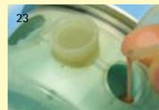
23 La cuvette est déposée sur sa partie inférieure. A présent, il est possible d'injecter la résine Opti-Cast par le haut.
