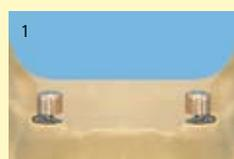
Les parties femelles (ici: boîtier de parties femelles pour duplication) doivent être positionnées n fonction de l'axe d'insertion parallèlement aux piliers divergents. Il convient pour cela de respecter absolument la procédure décrite fig. 3 à 13.
