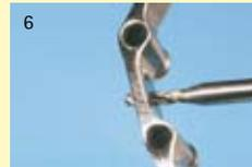
6 A l'aide de Diatit-Multi-drill 1,4 et avec de l'huile de forage et de fraisage, on fore un trou dans l'axe de vissage d sir .
