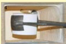
4 Pour éliminer la cire, enfourner le cylindre pendant 30 mn dans le four chauffé à 900° C. Sortir du four et laisser ensuite refroidir.
