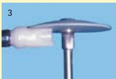
Pour le fraisage des matériaux tels que la vitrocéramique au disilicate de lithium ou la zircon, les pointes diamantées dtg sont idéales.
