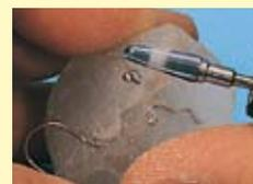
La forme conique légèrement plus étroite de ces fraises à grosse denture croisée assure un fraisage rationnel et précis.
