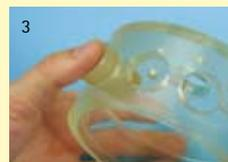
3 Les bouchons en caoutchouc se placent dans les ouvertures d'injection.
