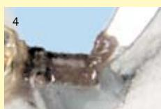
Préchauffer légèrement le modèle en revêtement (50-100°C), Superflux s'écoule ainsi plus facilement dans le joint de soudure.
