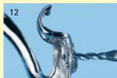
Les ouvertures sont ensuite travaillées avec le Diatit-Multidrill de diamètre 1,5 mm.
