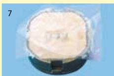
7 Déposer une feuille entre les deux parties du moule pour effectuer un essai de mise sous pression. Après cette mise sous pression, il sera possible de procéder à des caractérisations.
