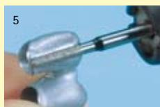
5 Divers matériaux peuvent être parfaitement fraisés avec une pointe montée abrasive Diabolo sans perte de temps à changer d'instrument.
