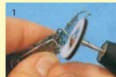
1 Les disques en toile imprégnés de pâte à polir sont plus efficaces. C'est un gain de temps puisqu'il n'y a pas d'apport de pâte à polir.
