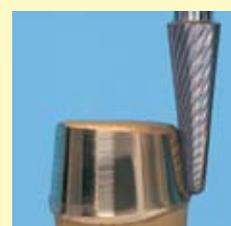
Après le contourage, finition de surface avec la fraise à polir. Même dans la zone du congé, un léger fraisage avec cet instrument permet d'obtenir une haute brillance de surface. Les rayons des fraises à polir, des fraises anatomiques et des fraises à cire sont parfaitement harmonisés les uns aux autres.
