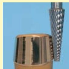
Après le fraisage anatomique, la fraise à polir procure une surface de friction extrêmement brillante. Il n'est plus nécessaire de procéder à un polissage supplémentaire.
