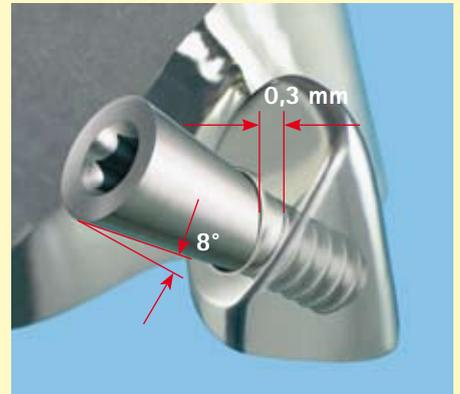
La tête de la vis pénètre sur 0,3 mm dans la partie primaire. C'est une garantie contre les fractures et une sécurité face aux forces de cisaillement. La tête conique de la vis assure une auto-rétention. La vis ne peut pas bouger.
