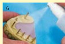
6 Si le modèle est mis en socle avec Exakto-Form, il faut préalablement l'isoler avec le liquide isolant Exakto-Form.
