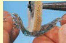
Les poils de chèvre particulièrement souples permettent de réaliser des polissages délicats tout en préservant le matériau.
