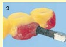
Pour bien fixer la douille filetée dans le matériau de revêtement, on visse une vis de fixation, REF 540 0070 6 recouverte de graphite colloïdale.
