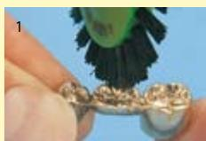
Les performances de ce polissage doux permettent d'éliminer en une seconde les traces de dégrossissage sur tous les alliages mous.
