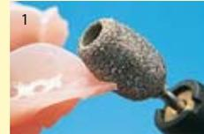
1 Les grains de diamant extra-gros et la forme en creux confèrent à cette pointe abrasive d'excellentes propriétés de meulage avec un dégagement thermique très limité.
