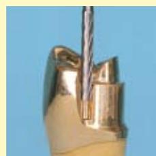
La fraise à rainures F538 3H 10 s'utilise exclusivement pour tailler des rainures. Pour ce faire, la fraise à rainures doit être utilisée uniquement dans l'axe vertical avec un mouvement ascendant/descendant. L'extrémité de la denture permet de prolonger les rainures en direction de la zone cervicale. En travaillant à une vitesse de 15.000 - 20.000 tours/mn<sup>-1</sup>, vous bénéficiez d'une bonne performance de coupe et vous obtenez une surface fraisée brillante comme un miroir.
