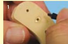
1 Le collage est parfait lorsque qu'un niveau de la surface d'appui, on applique aussi un peu de colle.
