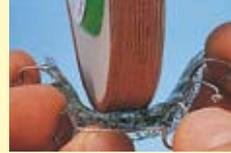
Les couches stables du pré-polissoir silicone sont composées de lin siliconisé. Ceci permet un polissage particulièrement agressif et rapide.
