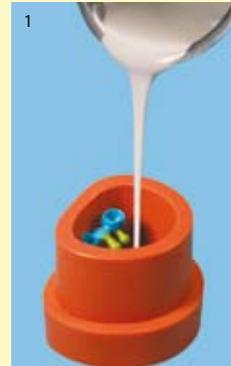
A une température ambiante de 21°C, vous disposez d'une plage de manipulation de 4 à 6 minutes pour couler les cylindres sans formation de bulles.
