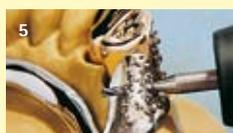
A partir de la face occlusale, forage aisé sur la fraiseuse à l'aide du Diatit-Multidrill Ø 0,8 ou 1,0 mm même en présence des alliages Cr/Co les plus durs.
