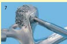
Avec le taraud ébaucheur en carbure de tungstène, réaliser le filetage. Le taraud ébaucheur n'élimine que de faibles résidus de céramique dans le passage fileté. Achever le filetage avec le foret à finir en carbure de tungstène. Lors de la réalisation du filetage, utiliser suffisamment d'huile de forage et de fraisage.
