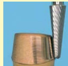
Après la coulé, l'élément est contouré avec la fraise anatomique. Le rayon de l'extrémité de la denture est étudié pour correspondre exactement à la fraise à cire. Le contourage du congé est ainsi rapidement exécuté.
