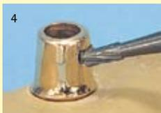
Le foret pointeau permet de déterminer le point exact de forage.
