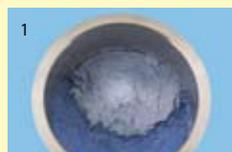
1 Mélangier le plâtre à socles Fluid-Rock selon le ratio 100 g de poudre pour 25 ml d'eau distillée jusqu'à obtention d'une consistance fluide.
