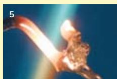
Effectuer la soudure comme d'habitude. Oxyd-Stop macro prévient efficacement l'apparition d'une couche d'oxydes.
