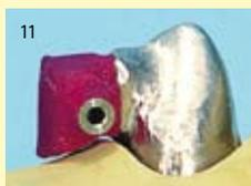
La vis est enrobée de résine Pi-Ku-Plast et intégrée au modelage. La vis ne peut être réduite qu'après la coulée.
