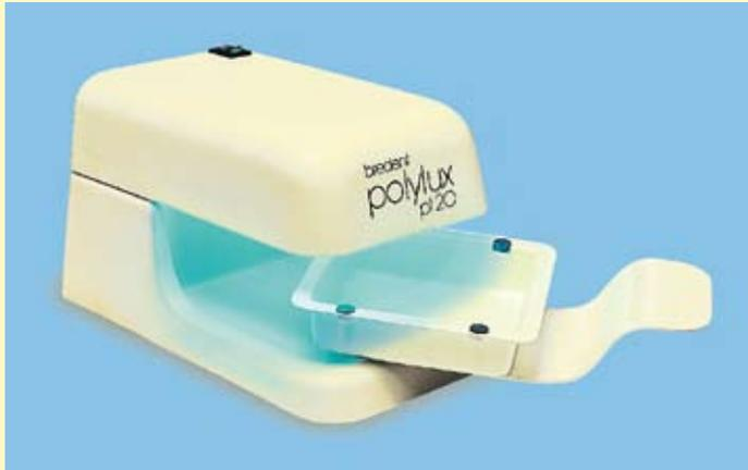
Appareil de photopolymérisation avec un réceptacle à matériau amovible pour placer l'objet facilement. La lampe de 9 watt illumine totalement l'enceinte et stimule la polymérisation des matériaux. Plage UVA 350 - 450 nm. Puissance : 20 mw/cm.
