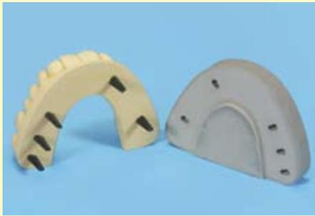
Un concept de dowel pins économique pour la confection de modèles. Du fait de la forme radiculaire spéciale, on peut utiliser un seul pin par die. Pour un bon ancrage dans le die, des surfaces collantes supplémentaires sont aménagées sur la face externe de la partie rétentive. La surface lisse de la résine High Tech permet une mise en place et un retrait faciles des dies.
