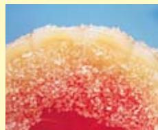
Pour le plâtre, les cristaux de rétention offrent suffisamment de surface afin d'assurer la fixation du Poly-Gel UV.
