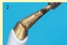
Les vernis espaceurs or et argent forment une couche d'env. 10 µm d'épaisseur. Le vernis espaceur bleu argenté micro forme une couche d'env. 5 µm.
