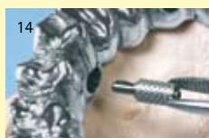
14 La douille filet e et la vis   tenon sont introduites dans le trou en position finale avant que la colle ne durcisse.
