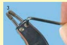
Lorsqu'un pan diamanté de l'insert est émoussé, il suffit de tourner l'insert pour profiter de nouvelles particules de diamant qui assureront une bonne préhension de l'intrados des couronnes.
