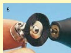
5 Différents diamètres de brosette permettent un polissage sûr et précis, même des zones difficiles d'accès.
