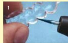
La denture rectiligne permet de découper facilement et avec précision les matériaux en plaque.
