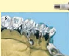
9 Le verrou à douille Snap est inséré dans sa gaine coulée.
