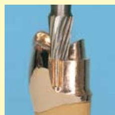
L'épaulement occlusal est aménagé à l'aide d'une fraise spéciale pour épaulement. Cette dernière est dotée d'une denture dont l'extrémité assure le surfaçage de la base de l'épaulement. La vitesse de travail parfaite pour cet instrument est de 15.000 - 20.000 tours/mn<sup>-1</sup>. Grâce à la denture avec dépouilles, la surface fraisée est brillante comme un miroir. Il n'est plus nécessaire de procéder à un polissage supplémentaire.
