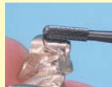
L'instrument H141 MH 23 meulant un congé. Le fonctionnement sans à-coup et sans vibration de la denture avec dépouille sécurise l'utilisateur.
