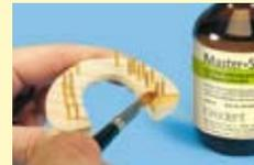
Master-Sep pénètre dans le plâtre et assure un scellement de surface. Master-Sep fait en même temps office de lubrifiant entre le pin et la gaine.
