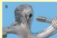
Obturer le filetage avec la vis de réglage et visser légèrement. La pression exercée par cette vis a pour effet de comprimer le cylindre de friction VC 1 et de réguler ainsi la friction de l'attachement.
