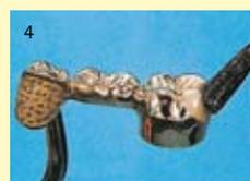
Bien agiter le flacon d'Oxyd-Stop-Métaux-Précieux et l'appliquer au pinceau sur les surfaces à protéger. Laisser sécher un court instant et le produit agit contre les oxydes.
