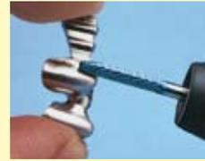
Bon pouvoir tranchant et surface lisse des pièces: D292 KM 23 – s'utilise par exemple sur les métaux précieux.
