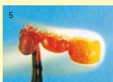
Appliquer une nouvelle couche d'Oxyd-Stop-Métaux-Précieux après chaque traitement thermique. C'est la seule façon de garantir l'absence d'oxydation.
