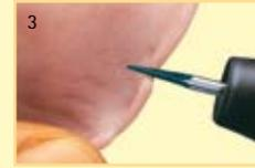
Les fraises Diatit découpent la résine avec exactitude et quasiment sans dégager de copeaux.
