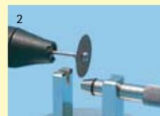
2 Monter l'écrou à six pans aimantable afin de bien centrer le nouveau disque à séparer sur le mandrin rapide - voilà c'est fini.
