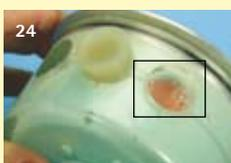
24 Pour chasser les inclusions d'air, on fait basculer la cuvette de part et d'autre
