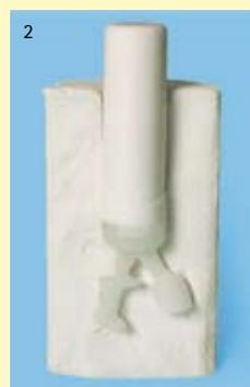
Grâce au démoulage en douceur à une pression de sablage de 2-4 bars, la précision d'adaptation des éléments est assurée.
