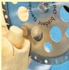
**Sciage contrôlé grâce à la conception à trous.** Giflex-TR est un disque diamanté à double face spécialement conçu pour les dies en plâtre et en résine. Les espaces à copeaux dans la zone diamantée assurent une évacuation rapide des poussières de meulage. Ils renforcent le pouvoir coupant du disque. Giflex-TR découpe rapidement et en silence même les plâtres et les résines de modelage les plus durs. Le disque ne vibre pas et ne se déforme pas.
