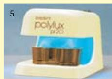
5 Le Poly-Gel UV ne durcissant que dans le photopolymérisateur, il est possible de mettre simultanément plusieurs montages en revêtement. C'est un gain de temps assuré.
