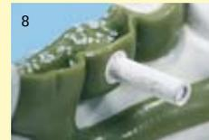
L'espaceur en céramique E est inclus dans la maquette jusqu'au niveau de sa section la plus importante.
