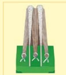
La faible largeur du polissoir Abraso Acryl assure un polissage précis. Après dégrossissage avec un papier d'émeri 120, en très peu de temps et sans grand effort, on obtient un pré-lustrage parfait.
