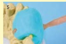
5 Le distributeur avec cartouche et canule est maintenu au niveau de l'orifice d'entrée. Bien fixer la clé sur le modèle avant d'actionner le pistolet...
