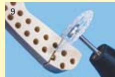
Avec le disque diamanté Giflex-TR Master x-tray, on scie les dies par le dessous.
