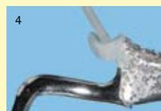
Appliquer Oxyd-Stop macro au pinceau sur les zones du châssis à protéger. Laisser sécher un instant.
