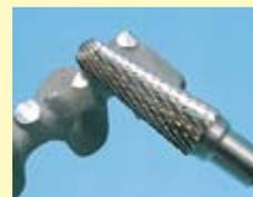
Grâce à une durée de vie plus longue, la denture avec dépouille réduit l'investissement en instruments. Notamment pour le travail des armatures céramo-métalliques, des économies substantielles peuvent être réalisées.
