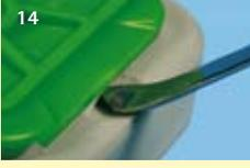
Le moule étant doté d'une encoche, on la retrouve à la base du modèle ce qui permet de dégager la plaque sans difficulté.
