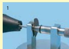
1 Insérer le tournevis aimanté sur le mandrin rapide et dévisser l'écrou à six pans en quelques tours. L'écrou à six pans est bien maintenu par le tournevis aimanté.
