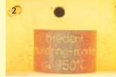
Jusqu'à 950°C, les cylindres restent facilement identifiables.
