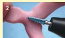
La grosse denture du D194 KG 40 (photo 3) et du D194 KG 50 (photo 2) garantit un dégrossissage rapide et parfait de la résine.
