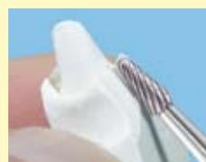
Des quantités de plâtre importantes s'enlèvent rapidement avec la grande surface de la fraise. En même temps, l'on obtient une surface lisse.
