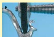
6 Cette brosette à noyau métallique (REF 350 0063 0) est taillée en pointe et très dure du fait de ses poils courts. Cela permet un polissage agressif sur des éléments métalliques et des zones de transition très fines.
