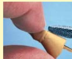
D263 KG 60, de par sa forme et sa grosse denture, convient au meulage des dies en plâtre.
