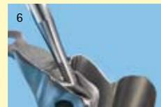
Après la coulée, réaliser le pas de vis avec le foret taraud sous apport abondant d'huile de forage et de fraisage.
