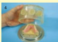
4 Afin de parfaitement positionner les tiges d'injection, le modèle et la partie supérieure de la cuvette sont assemblés comme illustré. Un aimant situé sur la plaque de fond renforce l'adhérence.
