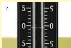
2 Pour compenser l'épaisseur de la préforme Gnathoflex, l'occlusion est augmentée de 0,5 mm.
