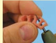
Ces fraises aux différents profils permettent une mise en forme dans des zones difficiles d'accès, comme par ex. les alvéoles de cette fausse genève.
