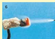
Oxyd-Stop-NP stoppe efficacement toute oxydation lors de la soudure au chalumeau. Les surfaces polies ne sont pas attaquées par les oxydes et la précision d'adaptation reste inchangée.
