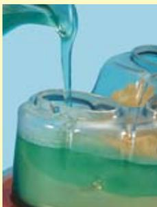
Brevest exakta M et Brevest exakta Speed ont été spécialement conçus pour la duplication au gel. Le modèle en revêtement se durcit après démoulage avec le durcisseur Duro Top.
