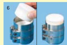
6 Serrer la vis du manchon métallique puis installer le bloc de résine qui fera contre-poids pendant la mise sous pression.
