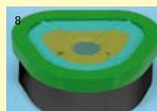
8 Pour le démoulage du modèle, on se sert d'une soufflette d'air comprimé.
