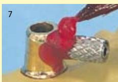
La vis et la douille filetée sont enrobées de Pi-Ku-Plast REF 540 0017 6.
