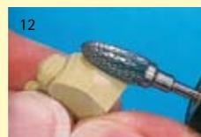
12 La résine durcie peut être fraisée et meulée. Le matériau étant bien stable, les dimensions ne varient pas et les modèles sont donc très précis.
