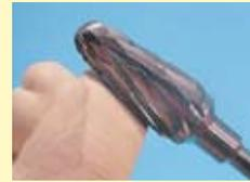
Les instruments avec une denture à dépouille sont conçus spécialement pour le fraisage du plâtre. La dépouille préserve l'effritement des bords.
