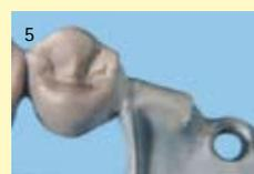
Sabler la zone de connexion après le brasage. Le matériau de soudure s'est parfaitement infiltré dans le joint. Superflux garantit la pérennité des connexions.
