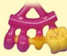
Maquette en cire avec positionnement direct des tiges de coulée. Avec ces tiges de cire profilées, aucune déformation de la maquette.
