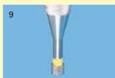
Avec la tige d'insertion, monter les parties femelles en résine dans les boîtiers métalliques de parties femelles à coller. Pour ce faire, les positionner sur le pilier.
