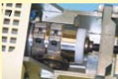
7 Introduire le cylindre dans le thermopress 400 et serrer les vis. Déclencher ensuite l'injection.
