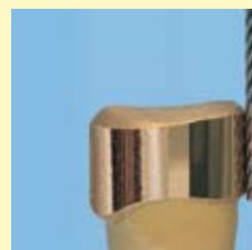
Grâce au chanfrein poli, les surfaces fraisées sont très brillantes. Sur de telles surfaces, il est possible de concevoir des éléments secondaires sans reprise du polissage. La précision est meilleure et c'est un gain de temps.
