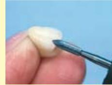
La denture KF est parfaitement bien adaptée au dégrossissage des incrustations céramo-métalliques.
