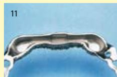
11 Squeletté dégrossi et contrôlé au niveau des points de friction, prêt à recevoir la partie femelle snap articulée avec la force snap idéale pour le patient.
