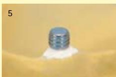
Fixer les parties femelles avec du plâtre, combler les contre-dépouilles jusqu'au niveau de la crête. Le plateau en plâtre garantit l'emplacement correct des parties femelles dans toutes les étapes de travail suivantes.
