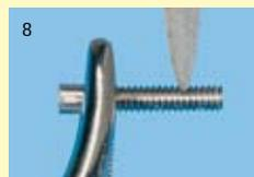
8 ...et la vis sont ramenées à la même longueur si nécessaire.
