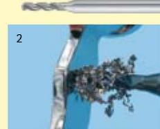
Avec le Diatit-Multidril de diamètre 1,5 mm, on fore le trou pour le verrou.
