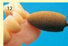
Pointe abrasive caoutchouc pour des surfaces lisses remplaçant le papier abrasif, dans la technique des résines. Le meulage est fin ce qui assure une préparation rapide et soignée pour le polissage final.
