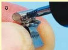
Avec le foret à aléser, le forage sera dimensionné à la taille voulue de 1,4 mm pour le foret à ébaucher. On aménage l'espace nécessaire pour la tête de vis conique.
