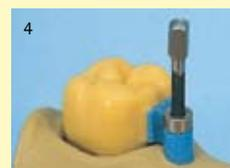
4 La vis de fixation recouverte de graphite colloïdal sécurise la mise en place précise de la douille fileté dans le matériau de revêtement.
