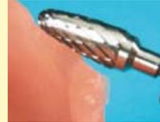
Fraises à dépouille pour un retrait rapide de la résine prothétique. Idéales également pour le plâtre.
