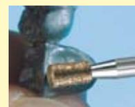
Dégrossissage des surfaces internes de châssis métalliques
