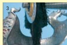
3 La forme en étoile polit rapidement et avec précision toutes les aspérités en exerçant un léger effet de battoir. La pâte à polir Abraso-Star K 80 (page 398) avec des composants de polissage incorporés vient parfaire le polissage.
