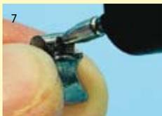
Avec le foret à taquet (1,2 x 2), le filetage est réalisé sur la profondeur désirée. Lors de ce forage, grâce à l'huile de forage Bredent, l'orifice sera propre et bien lisse.
