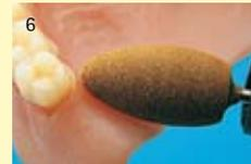
6 Grâce à la finesse du meulage, très peu de temps suffit pour une parfaite préparation du polissage. Cette pointe remplace avantageusement le papier de verre.
